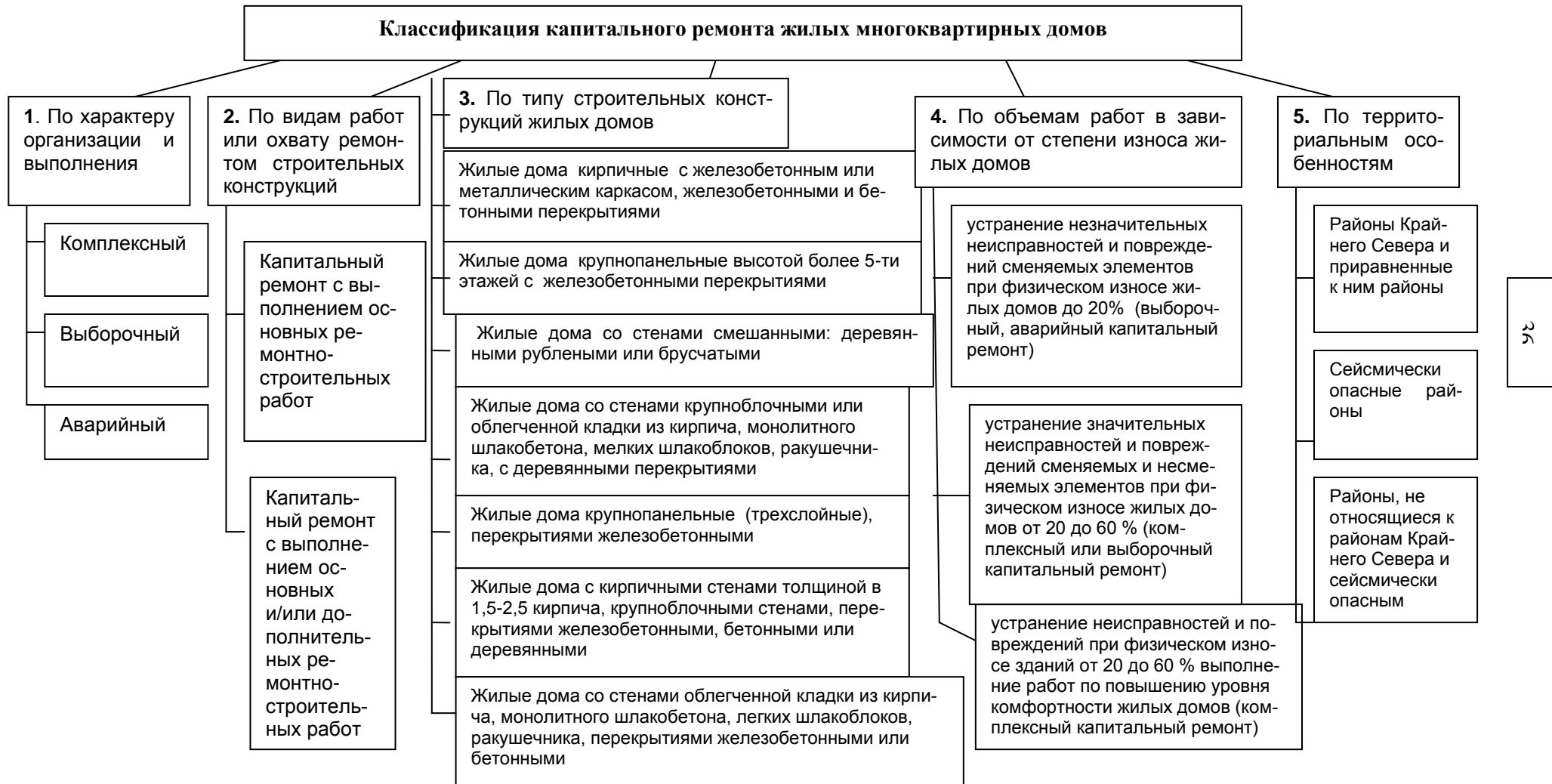
Рисунок 1.5. Классификация капитального ремонта жилых домов
